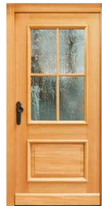
Innen- und Aussenseite in Lärche friesfurniert, Füllung abgeplattet, Glas Ornament 178 mit Fixsprossen, Drückergarnitur verzinkt schwarz passiviert, aufgesetzter Holzsockel
